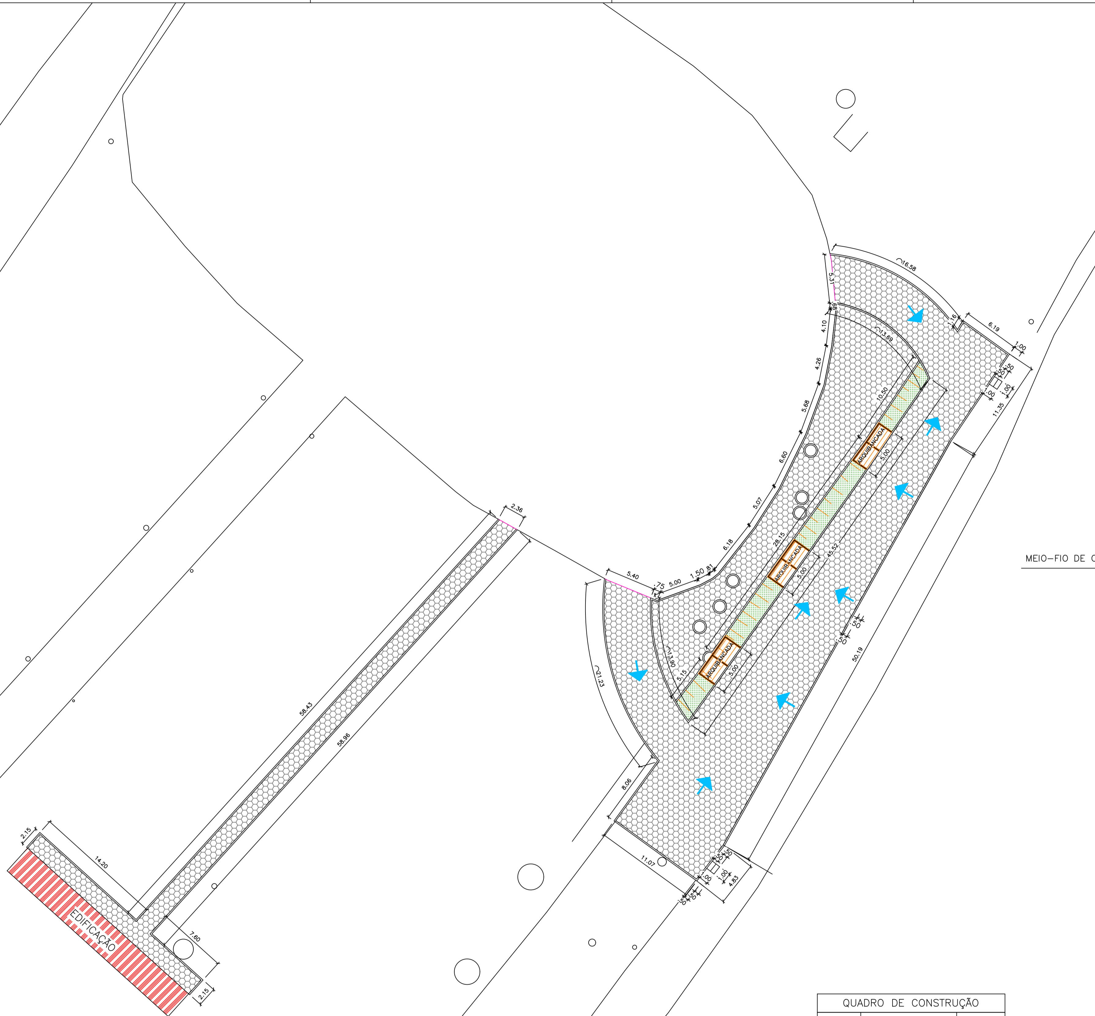
01 PLANTA BAIXA - CALÇAMENTO DE PISO INTERTRAVADO ESCALA 1:250
